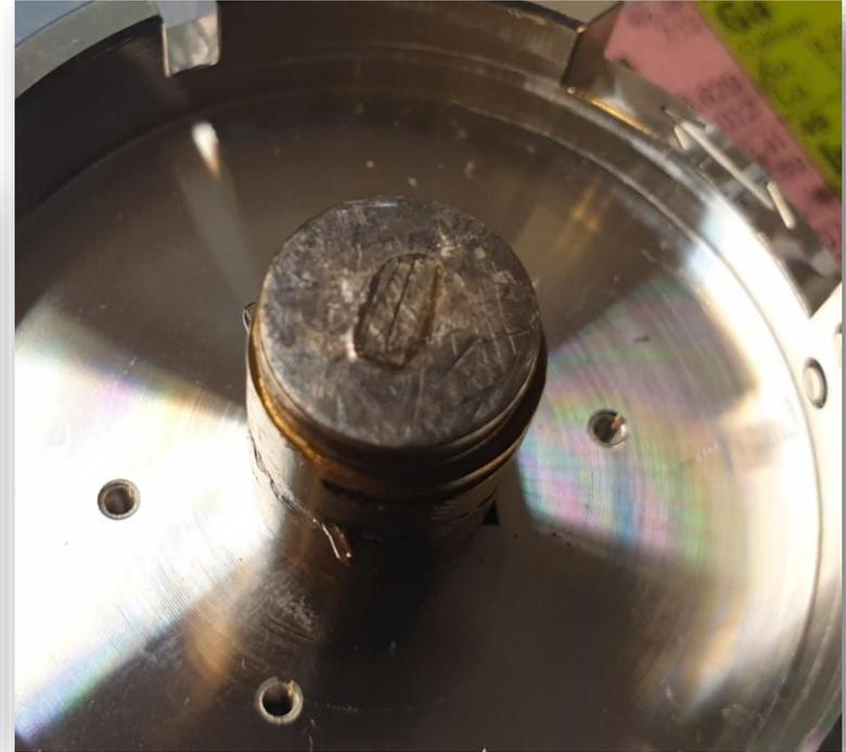
Polissage avec la MicroPol et observation facile sous binoculaire de l'avancement de la préparation.
