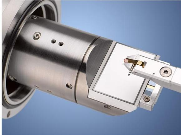
Le système OPTIMUS est spécialement conçu pour obtenir la meilleure géométrie pour vos analyses TKD. Le positionnement de l'écran phosphore en dessous de l'échantillon a deux avantages par rapport à la configuration TKD off-axis (avec un écran phosphore vertical) :
